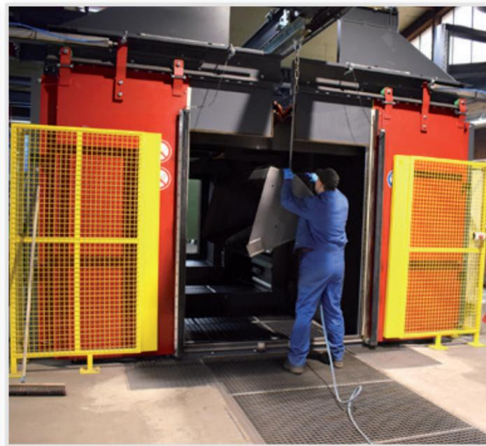
Die alte Strahlanlage entsprach nicht mehr den Kapazitätsanforderungen. Somit wurde in eine neue Durchlaufstrahlanlage, mit einer Gesamtlänge von 12 Metern, investiert. Die Anlage bietet den Vorteil, dass nun alle Produktgruppen von Kock & Sohn gestrahlt werden können. Nach dem Strahlprozess erhalten die Bauteile eine Oberflächenreinheit von SA 2,5. Diese ist für den nächs-
