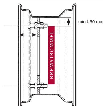
Bei der Verwendung von Radbolzen muss Platz für Ösenmutter mit Schlüsselweite 45 (mind. Ø 51 mm) zwischen Felgen und Bremstrommel vorhanden sein!
