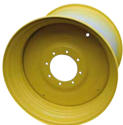
Scheibenrad mit abgewinkelter Radscheibe und Bombierung
